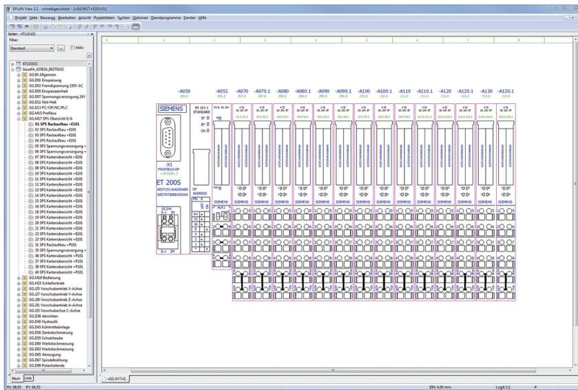
**Bild 3.** In Eplan Electric P8 wird auf Basis des Schaltplans eine vollständige Stückliste erstellt, die das Projekt über den gesamten Produktentstehungsprozess begleitet
